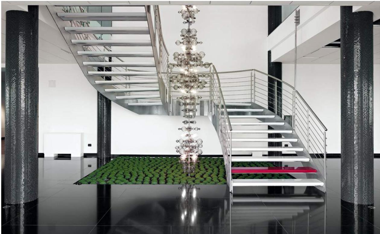
SPEQTRUM Concept Treppenstufen eignen sich sowohl für die Kombinations-Varianten als Tritts- und Setzstufen „einzeln“ als auch „auf Gehrung verklebt“. Einzellängen bis 3 m aus einem Stück sind für die meisten Treppenhäuser eine hervorragende Voraussetzung. Je nach Farbe und Dekor sowie Oberflächenfinish gibt es Stärken in 13/15/20/22/30/32 mm.
